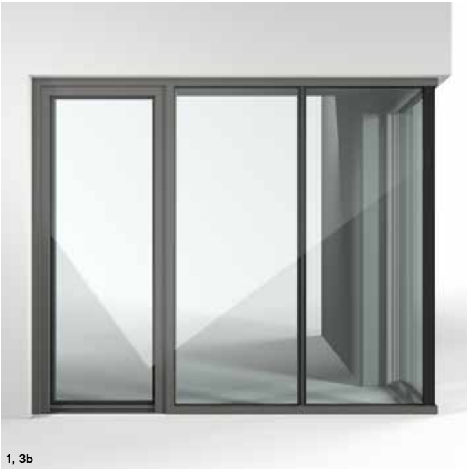
kozijnwand met ingezet, frame loze kozijn deur, drie vaste glaselementen met glasoverdekt middendeel, plus een volledig glazen hoek (90°), die aan de binnenkant is afgedekt met een aluminium hoekprofiel
