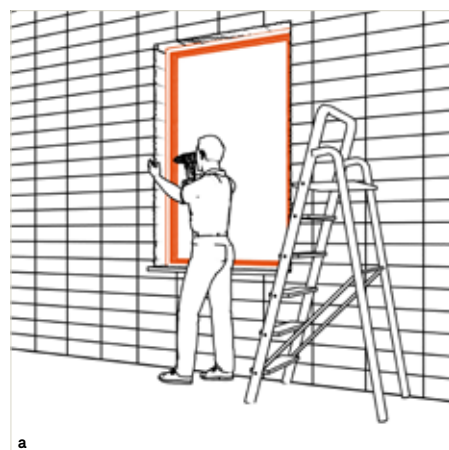
Het kozijn wordt geïnstalleerd in de zogenaamde natte ruwbouw-fase.
