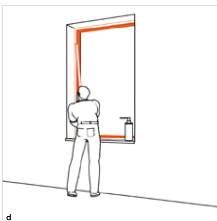
Indien nodig wordt de binnenkant vervolgens gekit voor een strakke look. Vervolgens kan de vleugel worden ingehangen.
