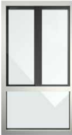
onderlicht als vast veld met tweevleugelig, frameloze vleugel in kozijn en glasoverdekt middendeel (type 402)
